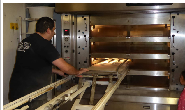
Le boulanger met le pain à cuire grâce au tapis roulant, et ça fait « pschitt » : il envoie de la vapeur d'eau pour que le pain brille et soit joli.
