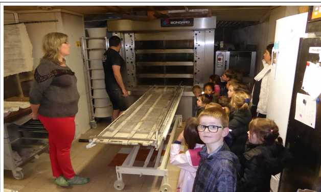
Le grand four et le grand tapis roulant où on dépose le pain et ensuite il roule vers le four.
